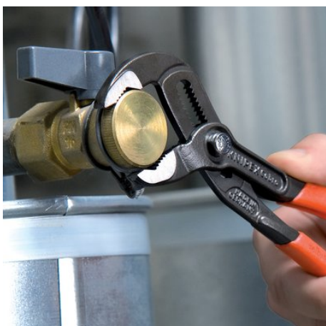
Tegen de draairichting in verzette tanden zorgen voor een zelfklemmend effect en verhinderen wegglijden aan het werkstuk
